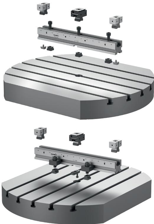
Il sistema di serraggio multiplo può essere montato in direzione longitudinale e trasversale su tavole di macchine con cave a T. Allineamento mediante tasselli. Fissaggio con viti o staffe di serraggio.
