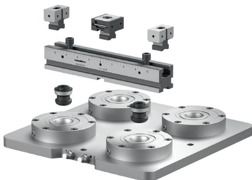
Adattamento del sistema di bloccaggio multiplo ai sistemi di serraggio meccanico a punto zero. Adatto a un calibro di 200mm. Foro di fissaggio  $\varnothing 25H6$  e viti di fissaggio M12.
