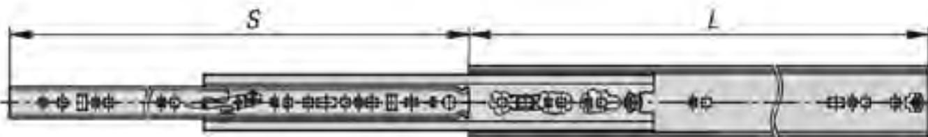
**Sovrastensione:** Lunghezza < Corsa - Le guide telescopiche in sovrastensione sono progettate per essere particolarmente stabili, poiché devono sopportare i carichi più pesanti quando sono aperte.
