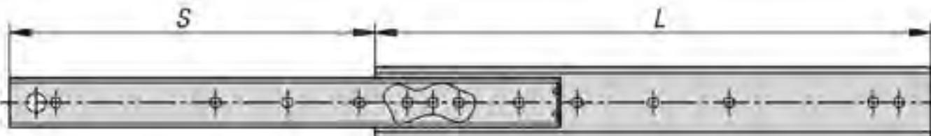
**Estensione completa:** Lunghezza  $\approx$  Corsa - Il loro speciale design conferisce alle guide telescopiche ad estrazione totale una maggiore stabilità, poiché una guida telescopica ad estrazione totale deve sopportare carichi più elevati quando è aperta.
