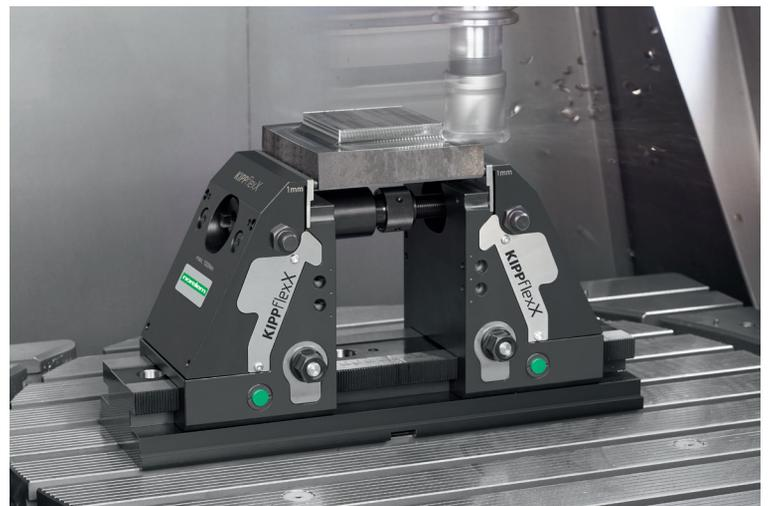
Lavorazione su 5 lati su una fresatrice a 5 assi. Accessibilità ottimale all'utensile per la lavorazione direttamente sulla morsa a 5 assi.
