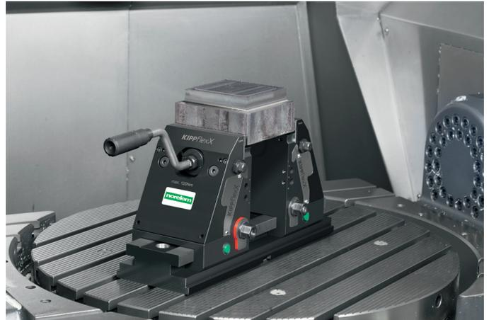
Staffa di fissaggio laterale con in funzione come morsa autocentrante. Tutte e due le ganasche sono chiuse, cosicché nell'atto di esercitare la forza, mediante piegatura eccessiva delle ganasche adiacenti, è generato un discendente sul supporto del pezzo da lavorare.
